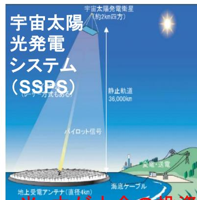
宇宙空間において太陽エネルギーで発電した電力をマイクロ波などに変換の上、地上へ伝送し、地上で電力に変換して利用する将来の新エネルギーシステム
