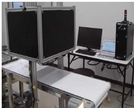
原料検査装置へのAI活用(良品検査)
