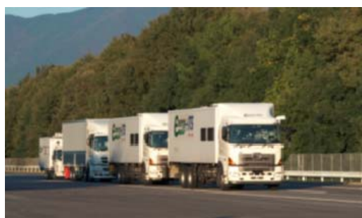
トラック隊列走行の実証実験 (NEDO/エネルギーITS 推進事業) (出所) 豊田通商
