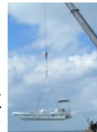
〔↑漁港整備前：クレーンで漁船を吊り上げる様子〕
