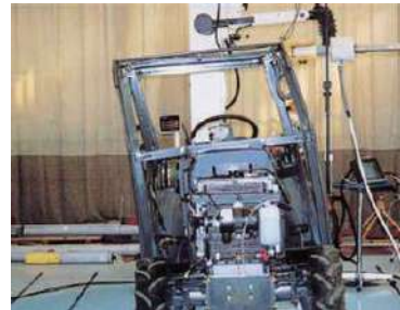
安全フレームの静的強度試験
