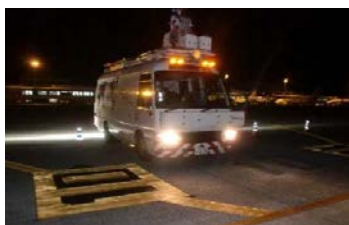
【MMS車両での計測】 GPSアンテナ、レーザースキャナー、カメラなどの機器を搭載し、走行時に舗装面や周辺の3次元座標データと連続映像を取得することで、路面性状調査と定期点検測量を実施
