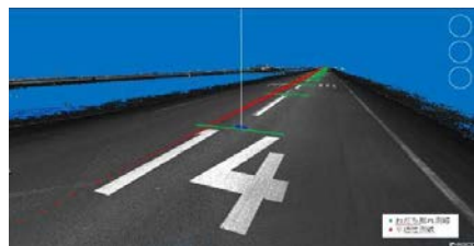
【MMS車両での計測】 GPSアンテナ、レーザースキャナー、カメラなどの機器を搭載し、走行時に舗装面や周辺の3次元座標データと連続映像を取得することで、路面性状調査と定期点検測量を実施
