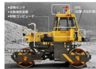
振動ローラ 出所：鹿島建設HP
