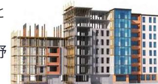
BIMの3D構造物モデル
