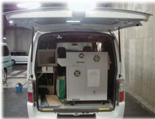
※ 貨物や携帯品の表面を拭き取り、採取した検体をイオン化し、質量を分析することで外装に付着した覚醒剤等、不正薬物及び爆発物の微粒子を短時間で探知することができる機器。
