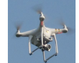
UAV(ドローン等)による3次元測量
