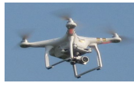
UAV(ドローン等)による3次元測量
