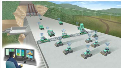
管制室から自動化された建設機械を制御
