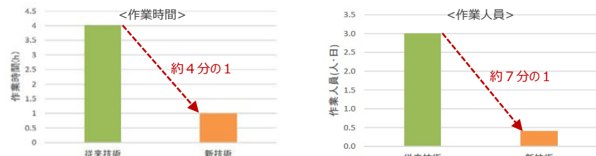
橋脚の現橋調査における作業時間及び作業人員の比較
