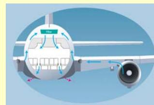
○航空機内の空気は、常に機外から新しい空気を取り入れ、機内で循環後、機外へ排出することで、約3分ですべて入れ替わる仕組み。
